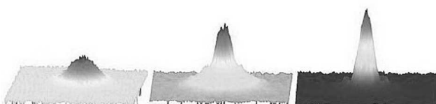
Rys. 10. Trójwymiarowe mapy rozkładów pędowych w przypadku (od lewej): chmury atomów termicznych ( T = 500 nK), przejścia fazowego ( T = 250 nK) i czystego kondensatu BE ( T < 70 nK)
